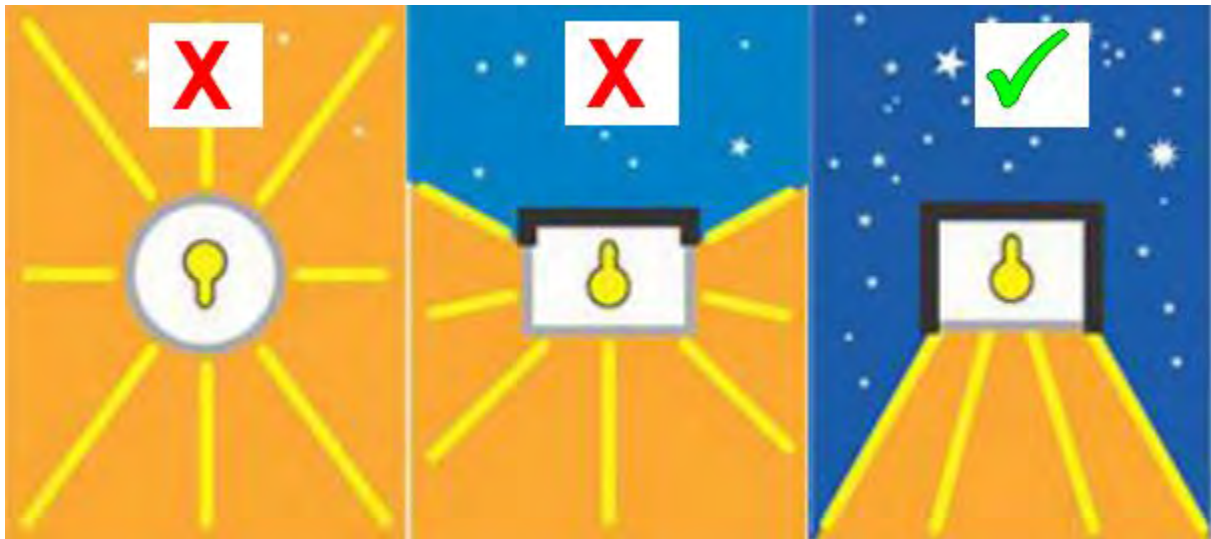
Abbildung 14: Schematische Darstellung der Ausleuchtung in Abhängigkeit von der verwendeten Abschirmung des Leuchtmittels. Links: Ohne Abschirmung, Mitte: Unzureichende Abschirmung. Rechts: Ideale Abschirmung mit nur nach unten gerichtetem Lichtkegel.
